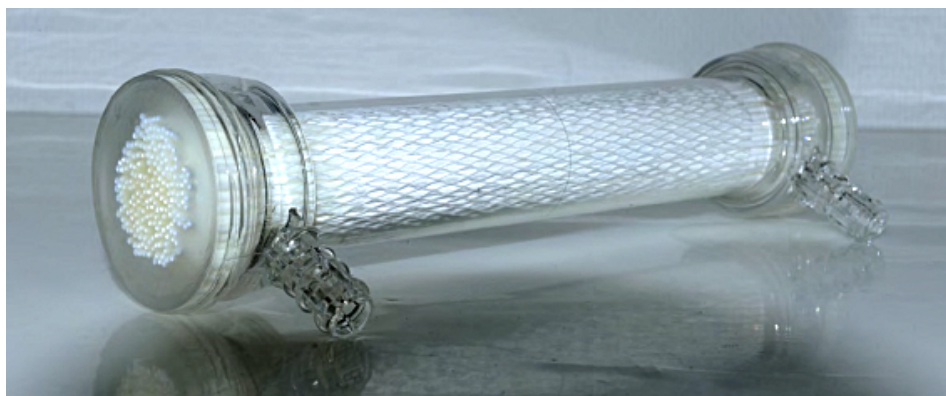
Abbildung 5: Prototyp Modul mit einer Membrantrennfläche von ungefähr 0,07 \text{ m}^2 (ca. 50 Fasern).
