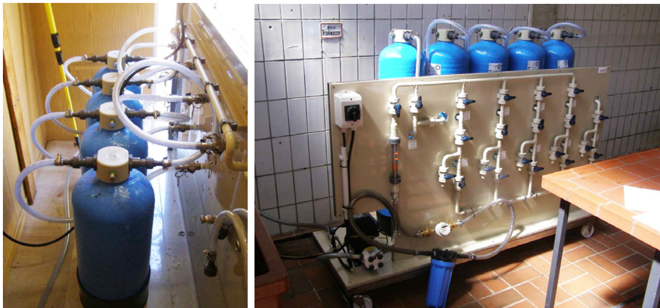
Abbildung 7: Versuchsanlagen mit Kokosnuss-Aktivkohle für industrielles Abwasser (links) und kommunales Abwasser (rechts)
