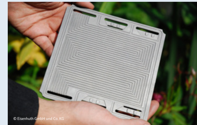
Elektrode mit Flowfieldstruktur aus dem Projekt RADAR
