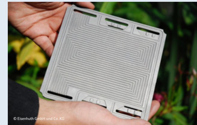
Elektrode mit Flowfieldstruktur aus dem Projekt RADAR
