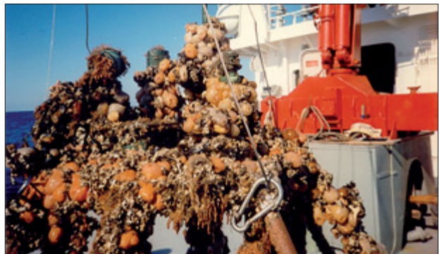
Abb.1: Messsonden u.a. für Leitfähigkeit, Druck, Strömung und Temperatur auf einem Sensorgestell nach 6-monatigem Einsatz in der Nordsee vor Sylt (© 4H-Jena engineering GmbH)
