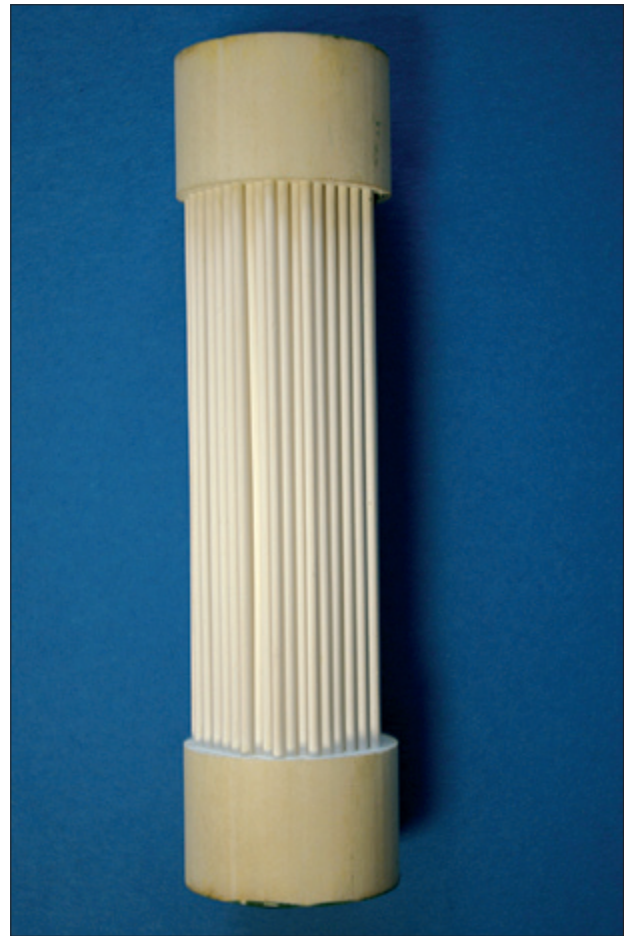
Abb. 2: Keramische Hohlfaserbündel für die Membrandestillation (© Fraunhofer Institut für keramischer Technologien und Systeme).
