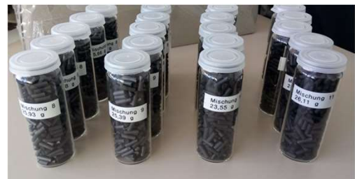
Abb. 1: Komposit-Aktivkohle VK 3 (holzkohlebasierend, 20 % Graphit, Bindemittel: Palatinose) [Bildquelle: UMSICHT]
