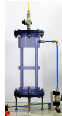
Stützstruktur von EnviroChemie zwecks Einbau der Rohrmembranen in das Demonstrator-Modul
