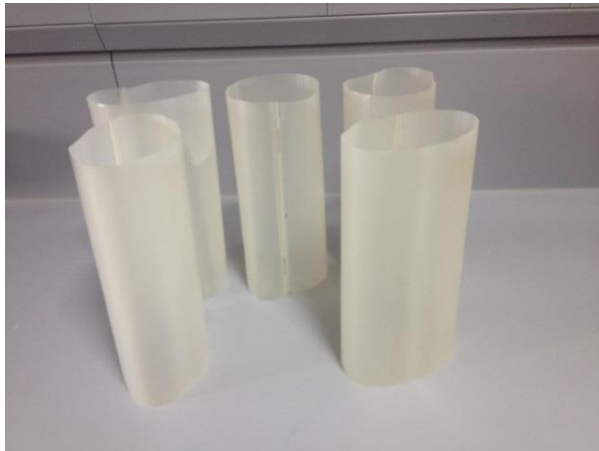
Mittels Schweissverfahren hergestellte Rohrmembranen
