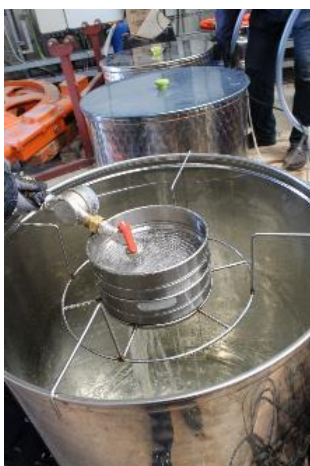
Probenahme über den Siebturm (hier nicht abgedeckt dargestellt)
