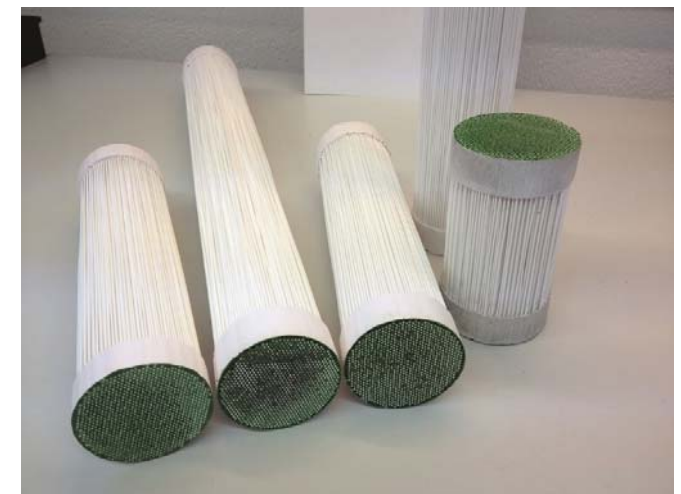
1000 Hohlfaser, Länge: 0,5 m, Fläche: 1 m 2
