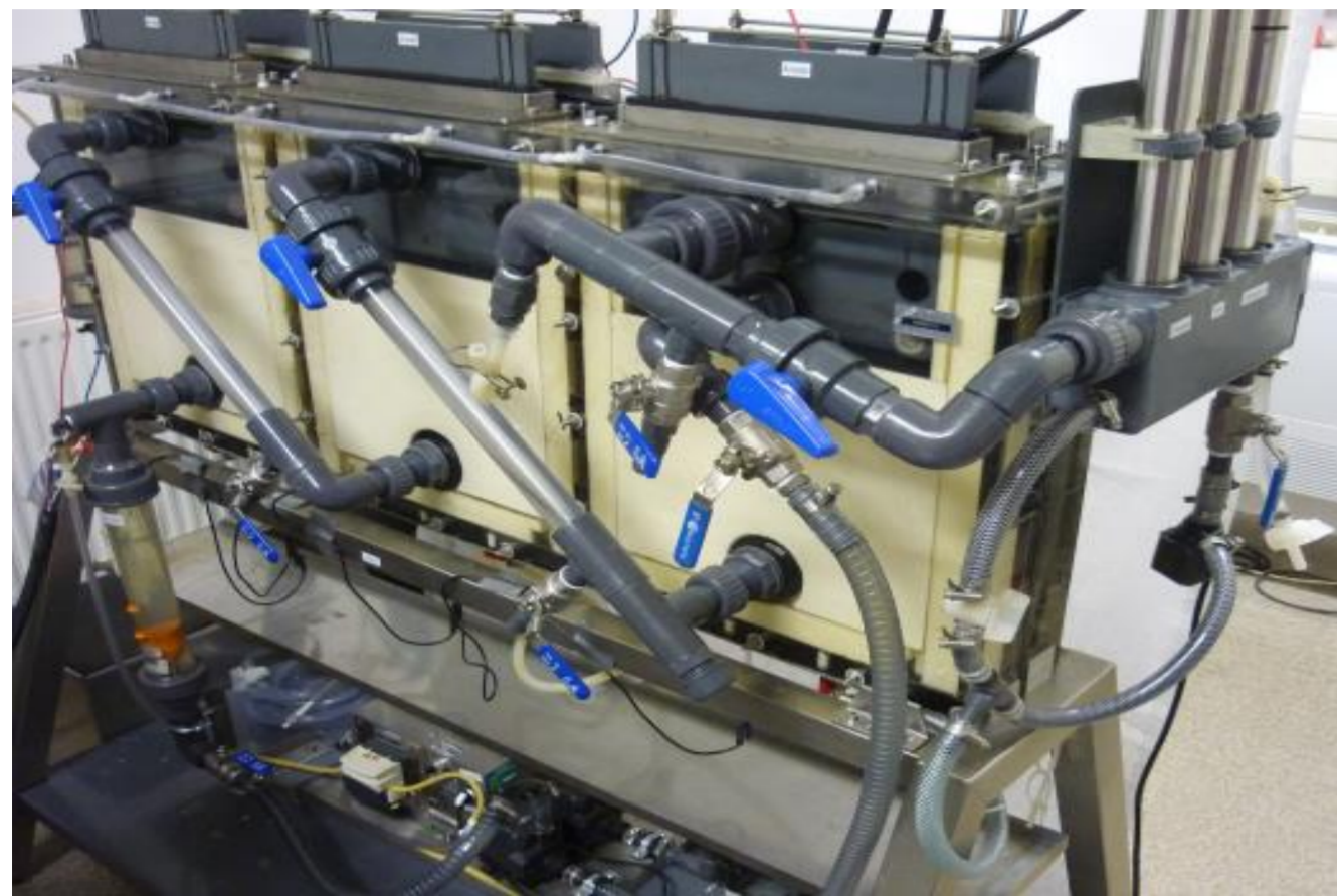
BES-Prototyp im Pilotmaßstab V_{ges.} = 50 \text{ L} , V_{Anode} = 20,7 \text{ L} , Graphitplattenanode A_{Anode} = 6242 \text{ cm}^2 Stahlgeflechtkathode A_{Kathode} = 16500 \text{ cm}^2
